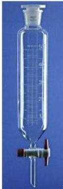
Imbuto separatore cilindrico graduato con rubinetto PTFE con tappo cono NS 29/32 ml 250
