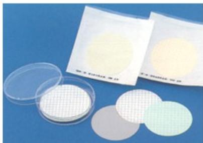
Membrane in nitrato di cellulosa sterilizzate singolarmente bianche retinate nero Ø 47mm porosità 0,45 µm conf. 100
