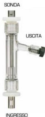
Cella a flusso continuo. Recipiente in vetro; sonda e camera di trattamento in lega Ti-6Al-4V. Si avvitava al Converter. Raccomandata solo per il trattamento di campioni a bassa viscosità che non richiedono prolungate esposizioni agli ultrasuoni. Progettata per dispersione e omogeneizzazione di flussi fino a 15 litri/ora. Adatta solo per applicazioni a bassa pressione.
