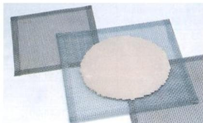
Reticella spargifiamma in ferro zincato disco in ceramica mm 120x120
