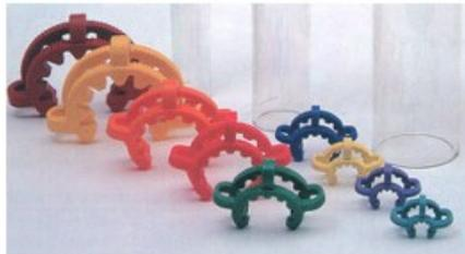
Pinza Keck per raccordo conico modello KC 29
