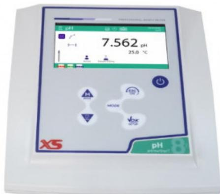
pH 8 PRO STIRRER pHmetro completo di elettrodo XS Standard T-BNC DHS con agitatore e accessori
