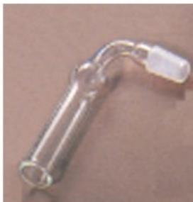
Tubi per cloruro di calcio con bolla e cono 29/32 lunghezza 120 mm
